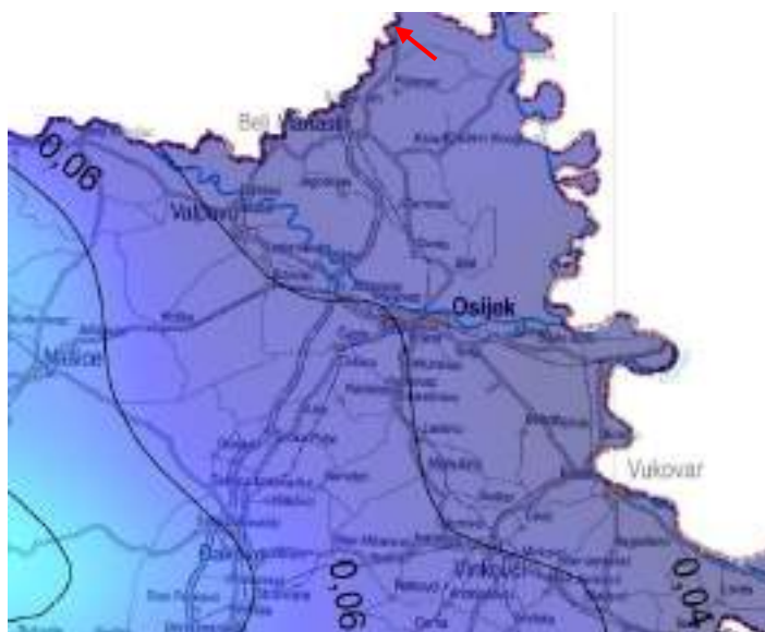
Slika 17. Vršna ubrzanja tla uzrokovana potresima za područje Općine Draž za povratni period 95 godina. Izvor: Karte potresnih područja RH, PMF Zagreb.
